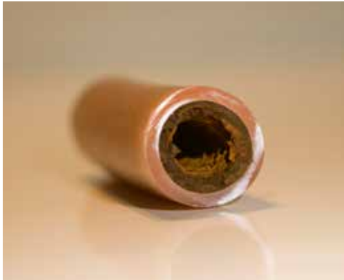
Das Hauptproblem alter Bodenheizungen: verschlammtes, versprödetes Kunststoffrohr.
